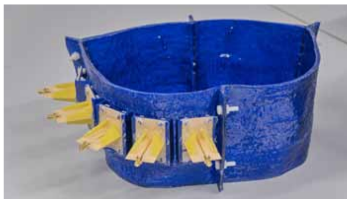
Experimentální zařízení, s mikroanténami (vlevo) a detail jedné z vyvíjených ultraširokopásmových antén
